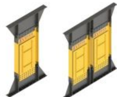
类型B：肋板式粘弹性阻尼墙
