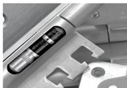
免维护内置式滚珠轴承专利技术，精密内置劲轴设计、合页受力面积大，借助开槽口的托力和开槽面的静摩擦力，高强度防抽螺纹轴芯，承重性能更强。
