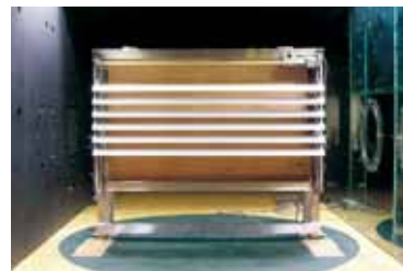
风洞测试的局部模型 / Wind Tunnel Testing - Partial Model
