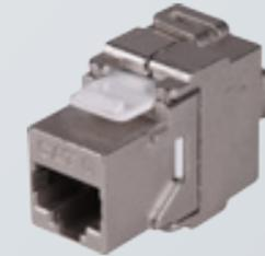
HONYAR鸿雁六类屏蔽模块为鸿雁六类屏蔽布线解决方案的一部分，所有性能指标包括NEXT、FEXT、衰减和回损都设计成保证250MHz宽带传输，确保极佳的长期可靠性以及其稳定，符合百兆以太网应用系统性能超越六类传输标准，适用于设备间与工作区的通讯插座连接。
