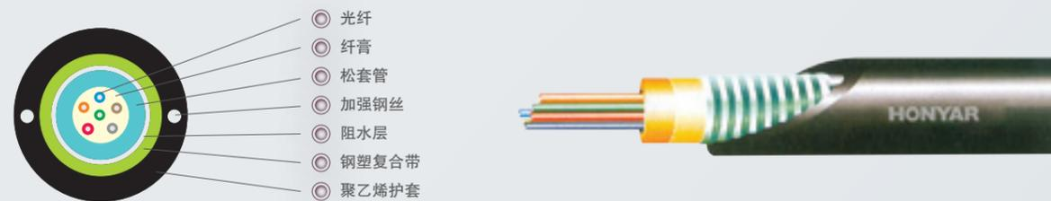
HONYAR鸿雁室外光缆是金属加强构件、中心管填充式、夹带钢丝的钢-聚乙烯粘结护套通信用室外光缆，由中心松套管、两根平行的钢丝加强构件和护套构成。
