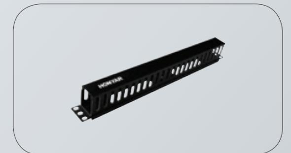
HONYAR鸿雁理线槽、理线架共有两种形式，一种为墙装式跳线管理器，另一种为机架式理线槽。墙装式跳线管理器（也称110过线槽），用于由110跳线架组成的配线间内跳线的管理，一般安装在水平区配线架和垂直主干配线架之间，它作为一个水平过线槽，用来引导跳线和交连线。
