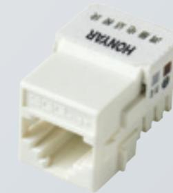
HONYAR鸿雁语音模块, 按语音电话系统专门设计, 六槽六芯结构, 符合语音传输标准, 适用于工作区的通讯插座连接。模块打线部分设计有保护盖, 确保导线全部端接并防止滑动。提供H卡口结构形式产品。
