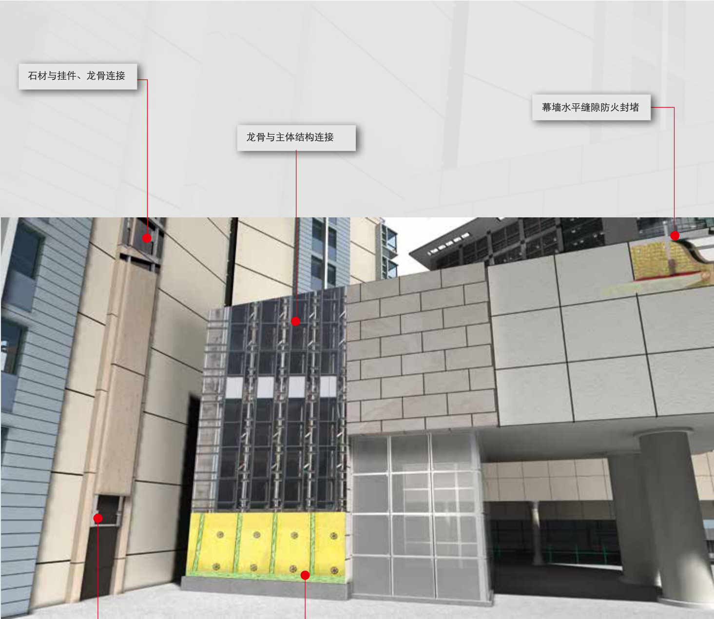
薄型板材与挂件、龙骨连接
