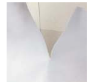
普通HDPE膜缺口易撕裂
