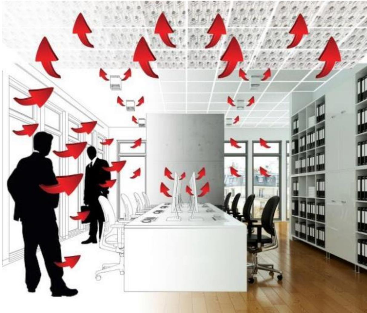
不同源头产生的热量不断被PCM 板吸收
