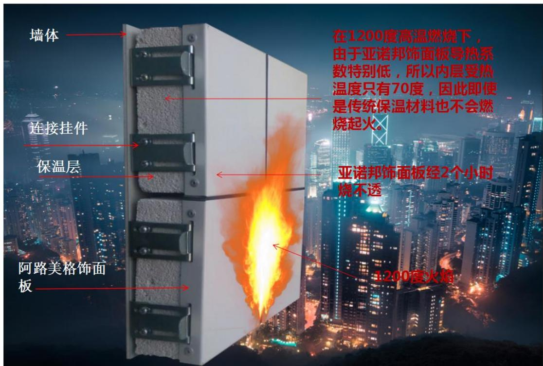
(二) 突出的保温隔热效果。由于每个聚苯颗粒都被耐高温的无机胶包覆，聚苯颗粒无法接触到氧气。无机胶聚苯板在保持聚苯板优良的保温性能外又可以做到不燃，整个保温装饰体系里，借助阿路美格 A 级防火复合板高强度的特点，使得整个保温装饰表面平整并可以保持不变形，导热系数可达到  $0.035-0.045W/m.K$ 。
