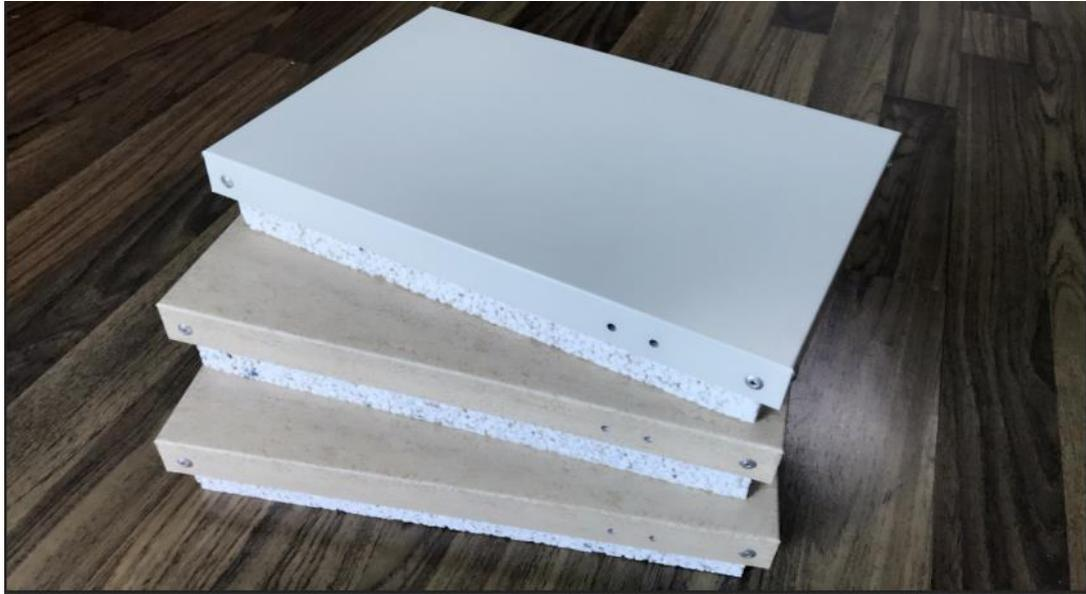
(三) 丰富的装饰效果。A 级防火复合板金属表皮可采用预辊涂铝、阳极氧化铝、不锈钢、铜、钛锌板等，表现效果丰富，灵活性高可做折弯、异型。最大限度满足建筑外墙的装饰设计需求。在表面涂层添加了光催化剂二氧化钛，可以分解板材表面有机污染物、烟尘、汽车尾气和空气中其它有害物质。将有害物质与板材隔开，经过雨水冲刷，帮助建筑物保持清洁。板材强度及剥离强度等各项检测满足室内外的使用要求，其膨胀系数与金属表面接近，减少了因两种材质不同膨胀系数引起的内应力。保证了面板的极致凭证，永不脱胶变形。
